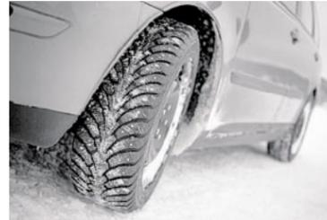
4. При перестановке ошипованных колес необходимо, чтобы они сохраняли прежнее направление вращения. Иными словами, менять местами колеса можно только с одной стороны автомобиля, а при хранении "зимней обуви" на каждом из них отмечают направление, в котором колесо вращалось на автомобиле.
